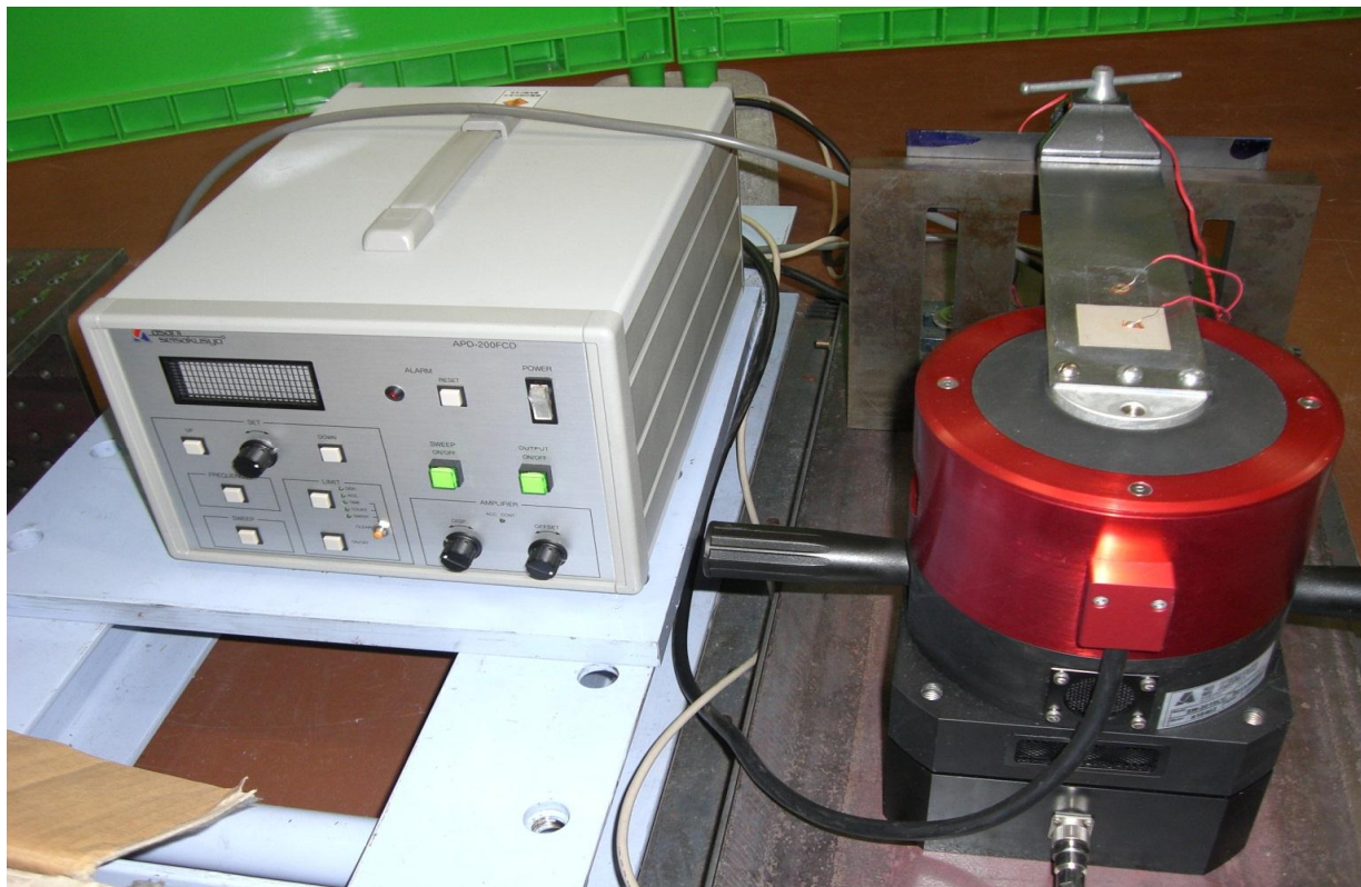
試作フィルムの振動特性を調べる実験
